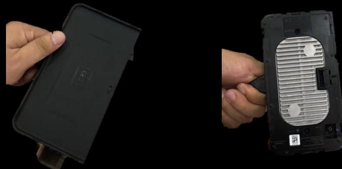
宝马5系低配加装，原装“被动式散热”无线充电模块
